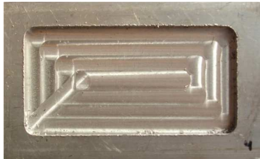
Figura 3.21 Cavity maquinada con estrategia espiral
