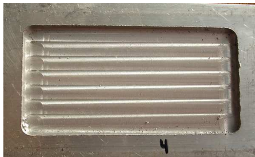
Figura 3.22 Cavity maquinada con estrategia un sentido
