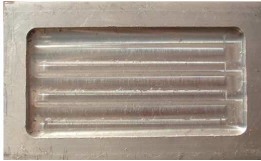
Figura 3.20 Cavity maquinada con estrategia zigzag
