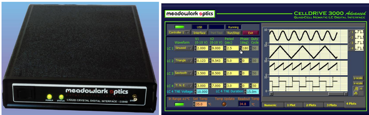
Figura 3.5: Fuente de poder para los retardadores variables (izquierda) y la interfaz gráfica del programa de control escrito en LabView (derecha) [18].
