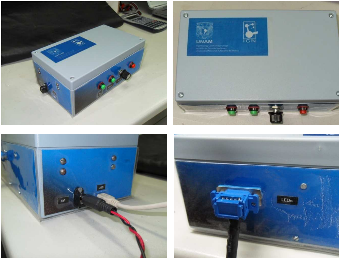
Figura 3.39. Sistema de control o caja de control del prototipo Track-Flat. a) Proceso de ensamblado. b) Prototipo final.
