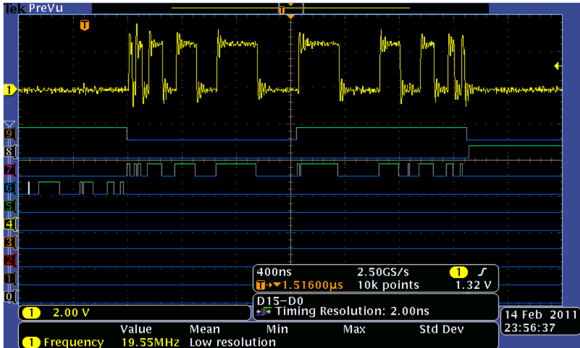
Figura 3.30. Pruebas en FPGA ProASIC3E A3PE1500 de Actel. Se realizaron simulaciones en modo continuo en donde se observa la forma en que varía el ancho de pulso durante los 2.5 \mu s que dura la presencia de señal en cada canal como se aprecia en a) y b). En c) y d) se muestran las señales medidas en el osciloscopio, en específico, el canal 8, bajo las mismas condiciones que la simulación, donde es de destacar la gran cantidad de ruido montado sobre la señal que se obtiene de los pines del FPGA, así como los sobrepasos durante los cambios de estado.
