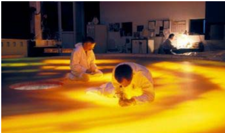
Figura I.3 Inspección de uno de los 4 espejos primarios del Very Large Telescope con diámetro de 8.2 metros (Foto tomada de sciencephoto.com).
