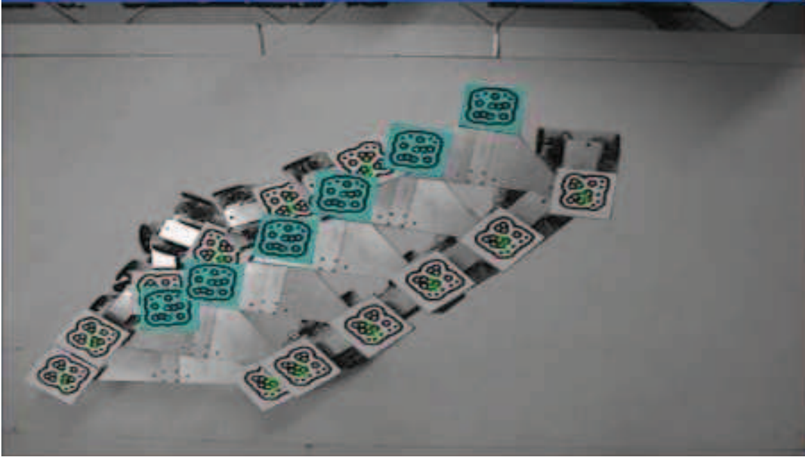
Figura VI – 2 Prueba movimiento rectilíneo sin giro en lazo abierto.
