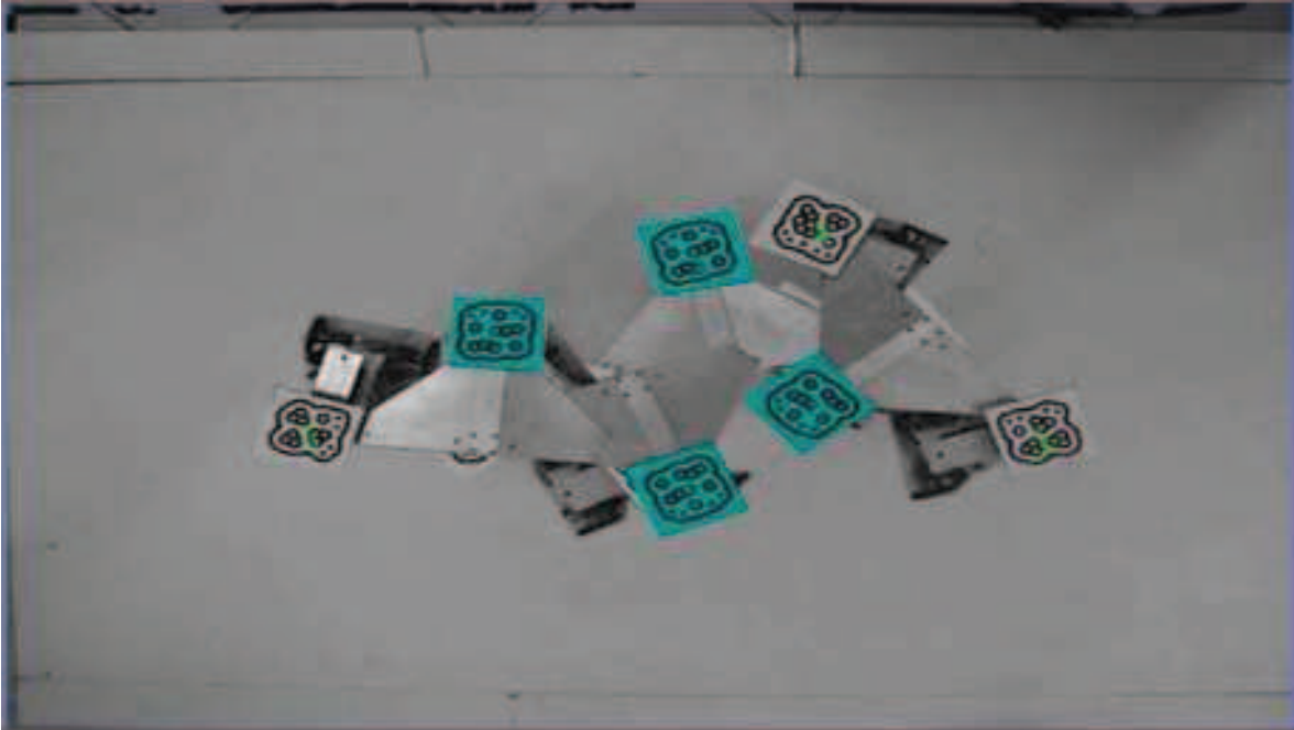
Figura VI - 47 Prueba de trayectoria circular con giro de la plataforma.
