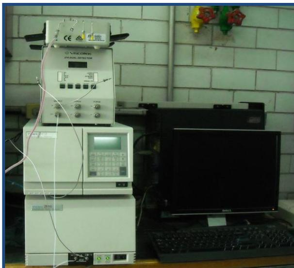
**Figura 5.7** Equipo de HPLC empleado en el análisis del diclofenaco
