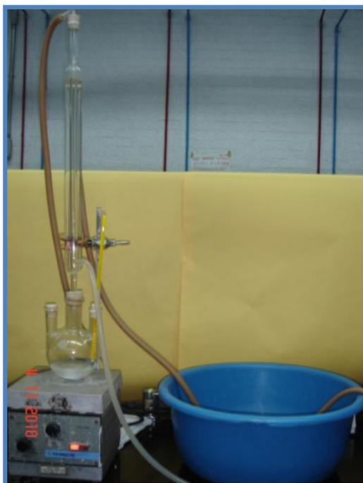
**Figura 5.5 Sistema para reacción de hidrólisis**
