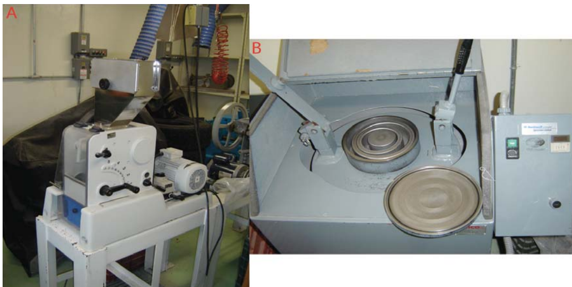
Foto 9. A. Molino de quijadas donde se quebraron las muestras. B. Molino de discos de acero endurecido para pulverizar las muestras para geoquímica e isotopía.
