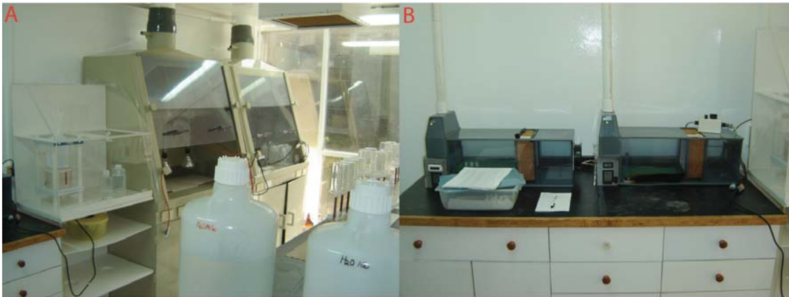
Foto 14. A. Cuarto de química ultrapura donde se observan campanas de evaporación y un destilador de ácidos. B. Parrillas de digestión de muestras.
