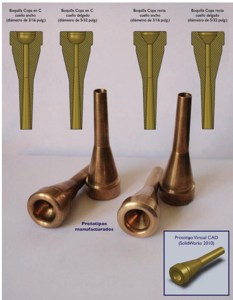
**Figura 4.5.** Prototipos de boquilla para trompeta. El tamaño del aro es estándar, el perfil de la copa son dos casos y el tudel en su parte externa tiene dimensiones comerciales.
