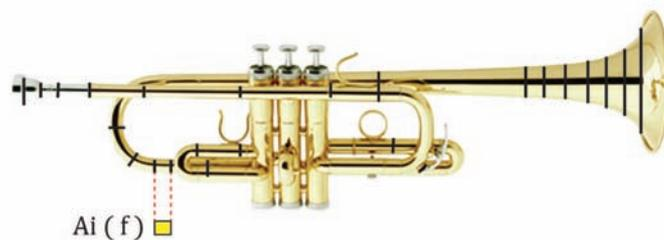
**Figura 2.26.** Propuesta de Kausel para determinar el sonido final de un instrumento con un diámetro de copa específico. La figura representa la división del instrumento en secciones (representado por la función  $A_i(f)$ ). (Imagen basada en "Optimization of Brasswind Instruments and its Application in Bore Reconstruction" Kausel, 2001. Reproducción realizada para fines de investigación).
