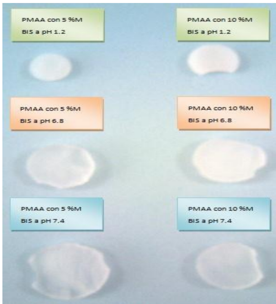
Figura 6. Hidrogeles de PMAA con diferente porcentaje de entrecruzante 5 y 10 %M BIS en su equilibrio de hinchamiento a los diferentes pH's evaluados.
