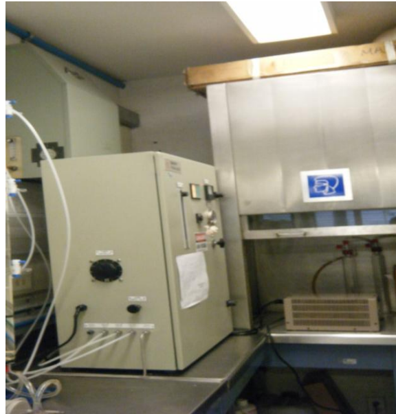
Figura 2. Generador de Ozono
