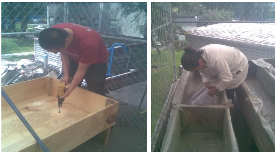
Figura 5.4 Perforación y forrado de cajones
