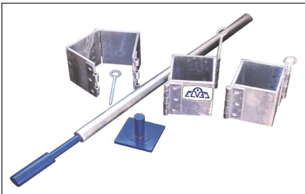
Equipo para prueba de valor cementante Fig. (3.12)
