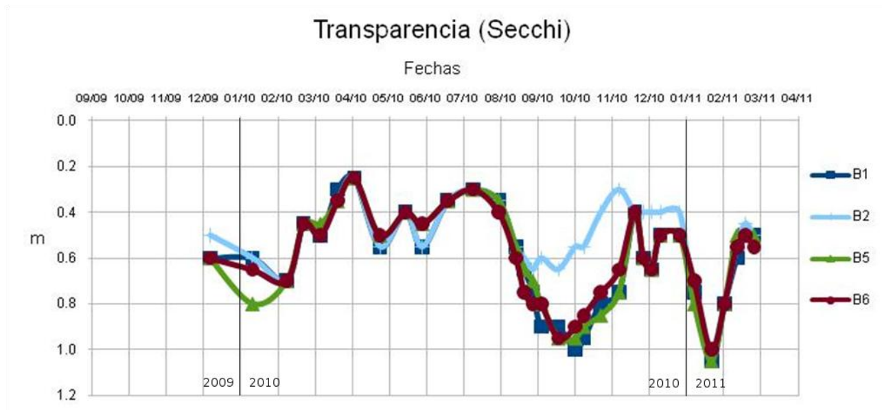
Figura 12. Transparencia por sitio (B1-B6) en el bordo las Maravillas. Los puntos 3 y 4 se excluyeron de las mediciones debido a su bajo nivel de agua, en donde el disco de Secchi fue siempre visible.
