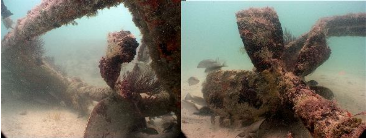
Figura 28.- Izquierda: cara de succión de una propela de bronce perteneciente a los restos de una embarcación hundida en el sitio arqueológico "Fipesco", localizado en la Sonda de Campeche. Derecha: cara de presión de dicha propela de bronce. Nótese la abundante colonización biológica de esponjas, briozoarios e incluso de corales blandos. Fotografía cortesía de la Subdirección de Arqueología Subacuática del INAH.
