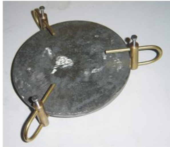
Figura 5.- Discos colectores empleados en el estudio de la caracterización de la biota sésil y en las pruebas electroquímicas para la evaluación de su deterioro por corrosión. Nótese el sistema de sujeción empleado.
