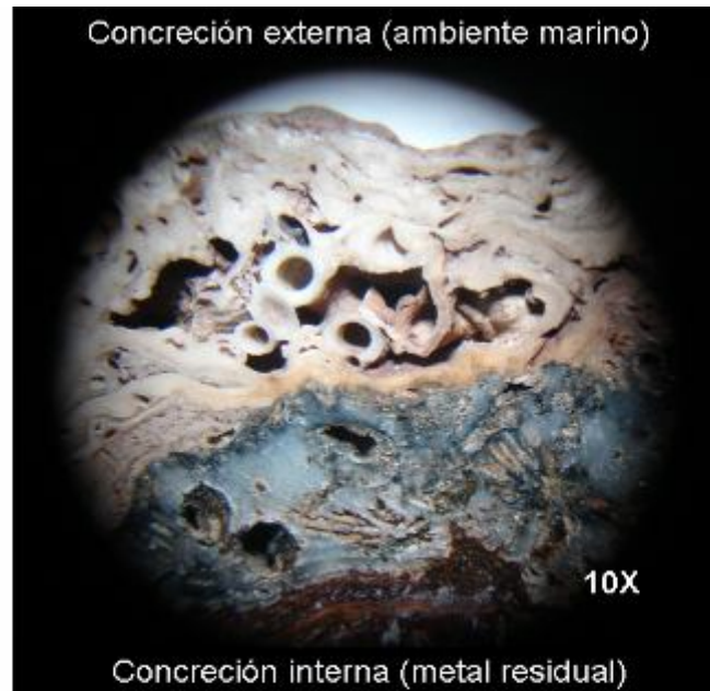
Figura 27.-Sección transversal de la concreción de una bala de cañón procedente del sitio arqueológico "Don Pancho" en la Sonda de Campeche. Nótese la difusión de los productos de corrosión desde la región interna hacia la región externa de la concreción a través de los restos de organismos de formas costrosas y que forman tubos calcáreos. Fotografía cortesía de la Subdirección de Arqueología Subacuática del INAH.
