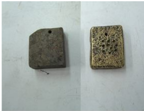
Figura 3- Probetas de hierro (izquierda) y de bronce (derecha) empleadas en el estudio de pérdida de peso por efecto de la corrosión, así como en el análisis de composición química elemental.
