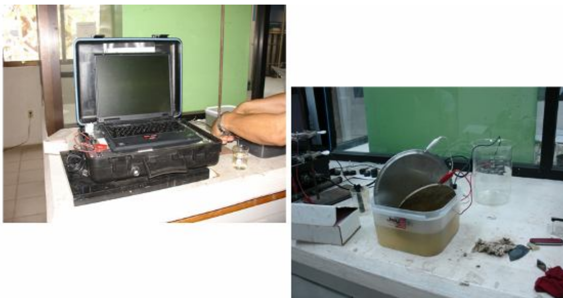
Figura 10.- Potenciostato (Izquierda) y celda electroquímica (derecha) empleados en las pruebas de polarización potenciodinámica para el estudio del comportamiento electroquímico del hierro y el bronce, así como para la determinación de las velocidades de corrosión de estos materiales.
