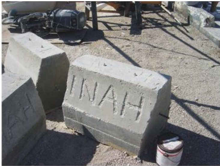
Figura 6.- Bloque de cemento empleado para anclar al fondo marino los módulos experimentales.
