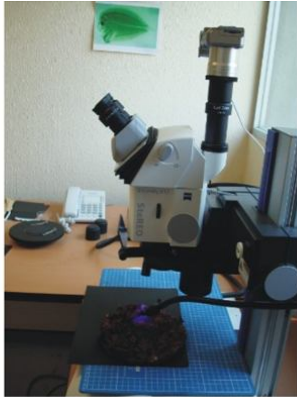
Figura 9.- Sistema de montaje de los discos colectores en el microscopio para la obtención de los fotomosaicos.
