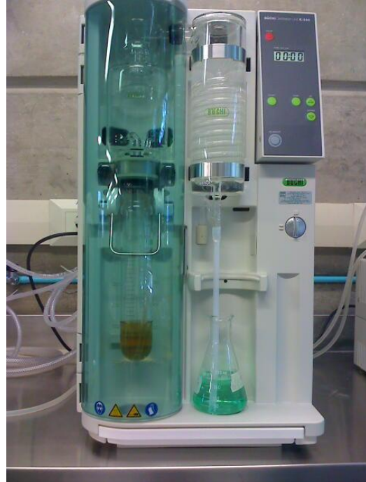
Figura 2.3 Unidad de destilación.
