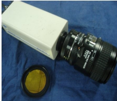
Figura 6. Cámara CCD Kodak Megaplus ES1.0 y filtro verde.
