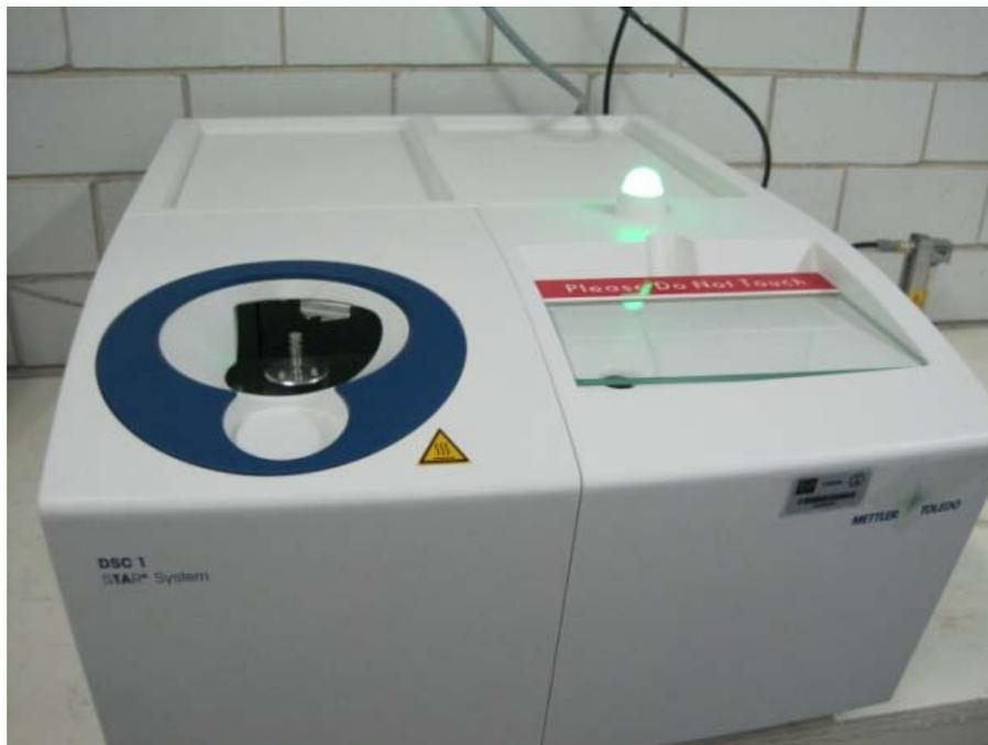
Figura 17. Fotografía del calorímetro DSC-1
