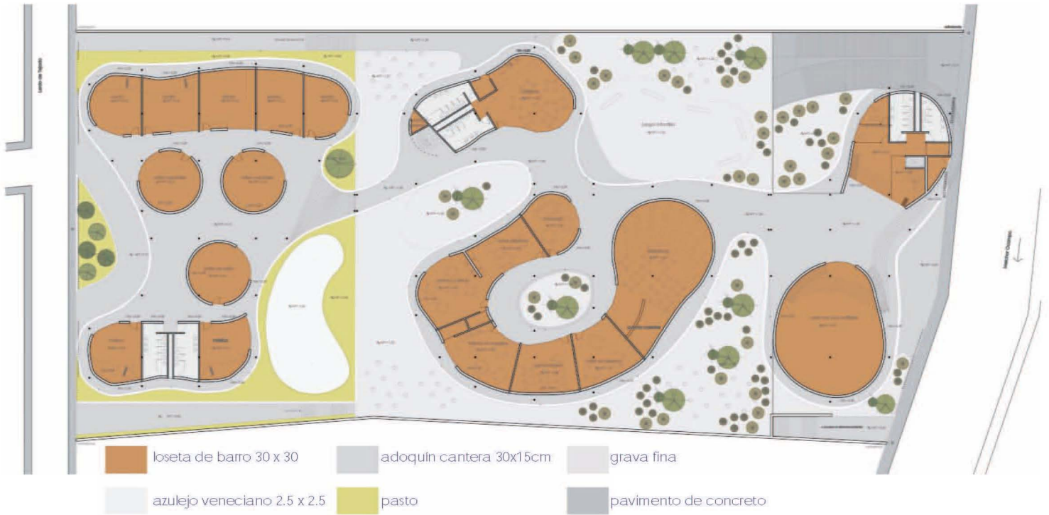
Gráfico: diagrama de materiales en pavimentos
