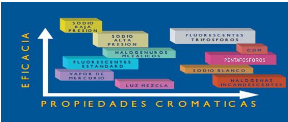
Figura 20. Propiedades cromáticas vs Eficacia en diferentes tipos de lámparas. Fuente: Guía técnica de Iluminación. Fundación de la Energía de la Comunidad de Madrid.
