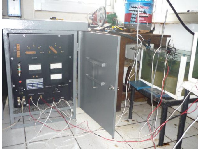
Foto 2.12 Aplicación de Protección Catódica por corriente Impresa a los electrodos de trabajo.
