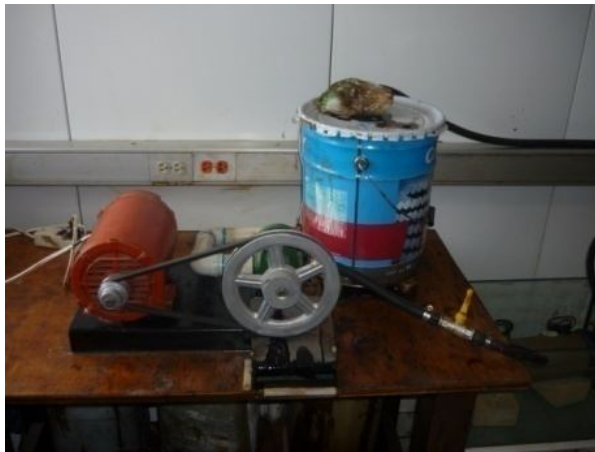
Foto 2.10 Conexión contenedor de crudo a bomba de engranes.
