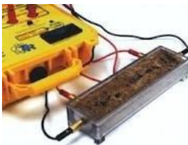
Figura 3.10 Medición de resistividades
