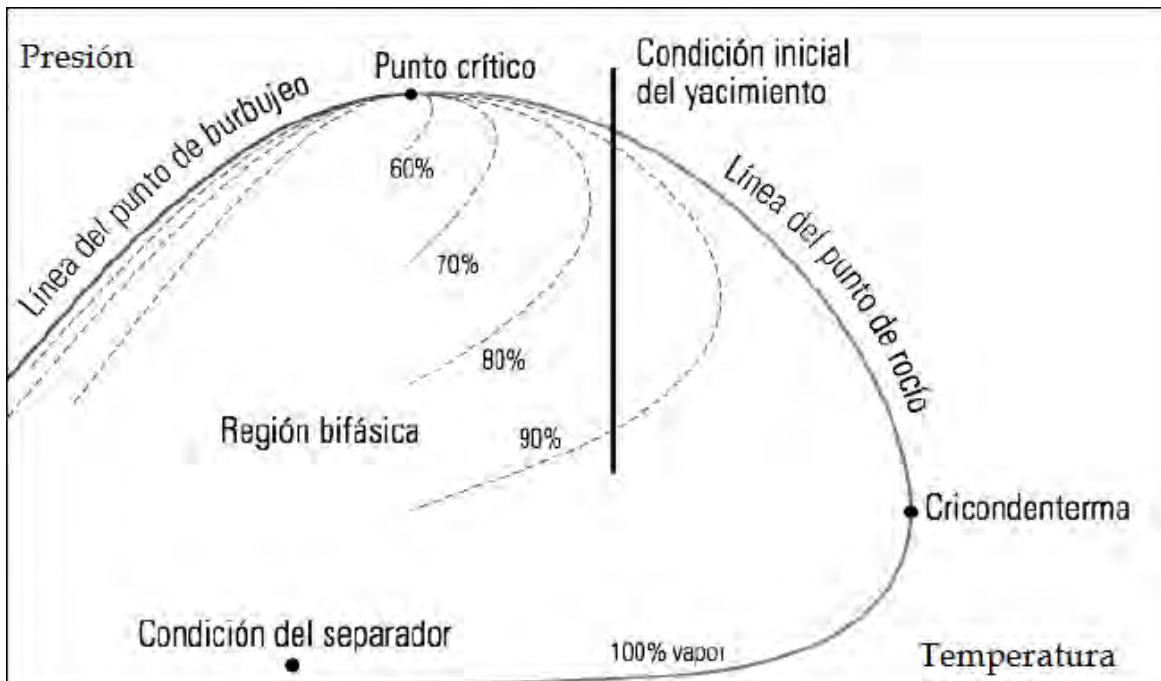
Figura 1. Envolvente de fases típica para un gas y condensado. Li Fan, Et al. Revisión de los yacimientos de gas condensado. College Station Texas.EUA.2006.
