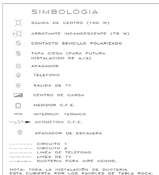
FIGURA 86. Simbología de los planos de instalación eléctrica
