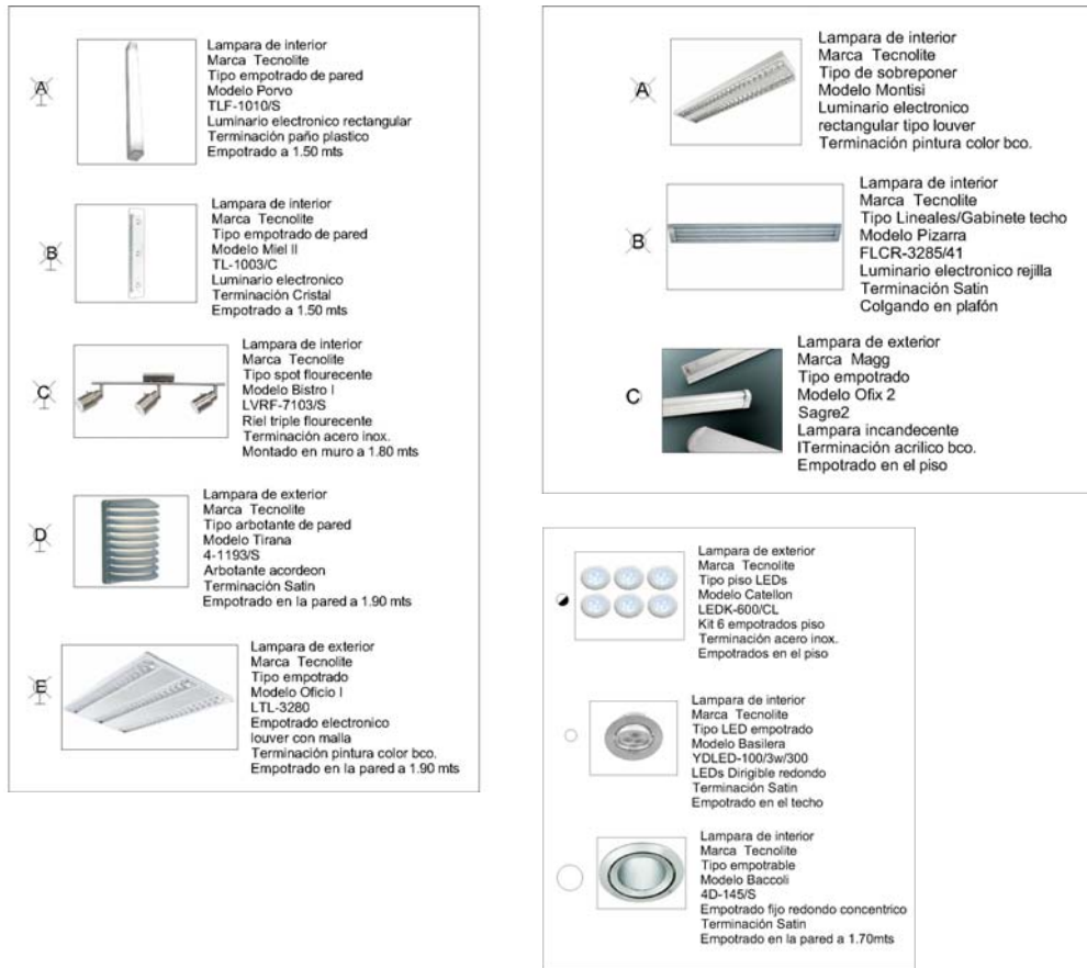
FIGURA 90. Tipo de luminarias utilizadas en el proyecto
