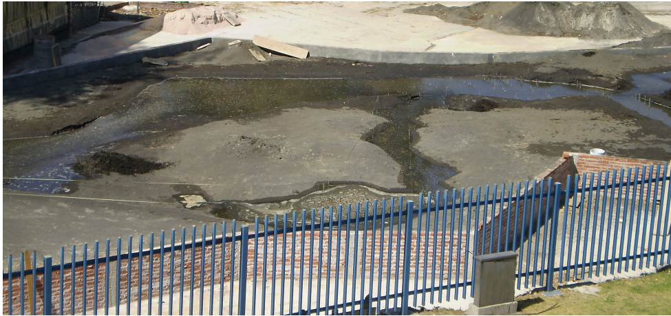
Figura 3.4: Modelo físico de ríos
