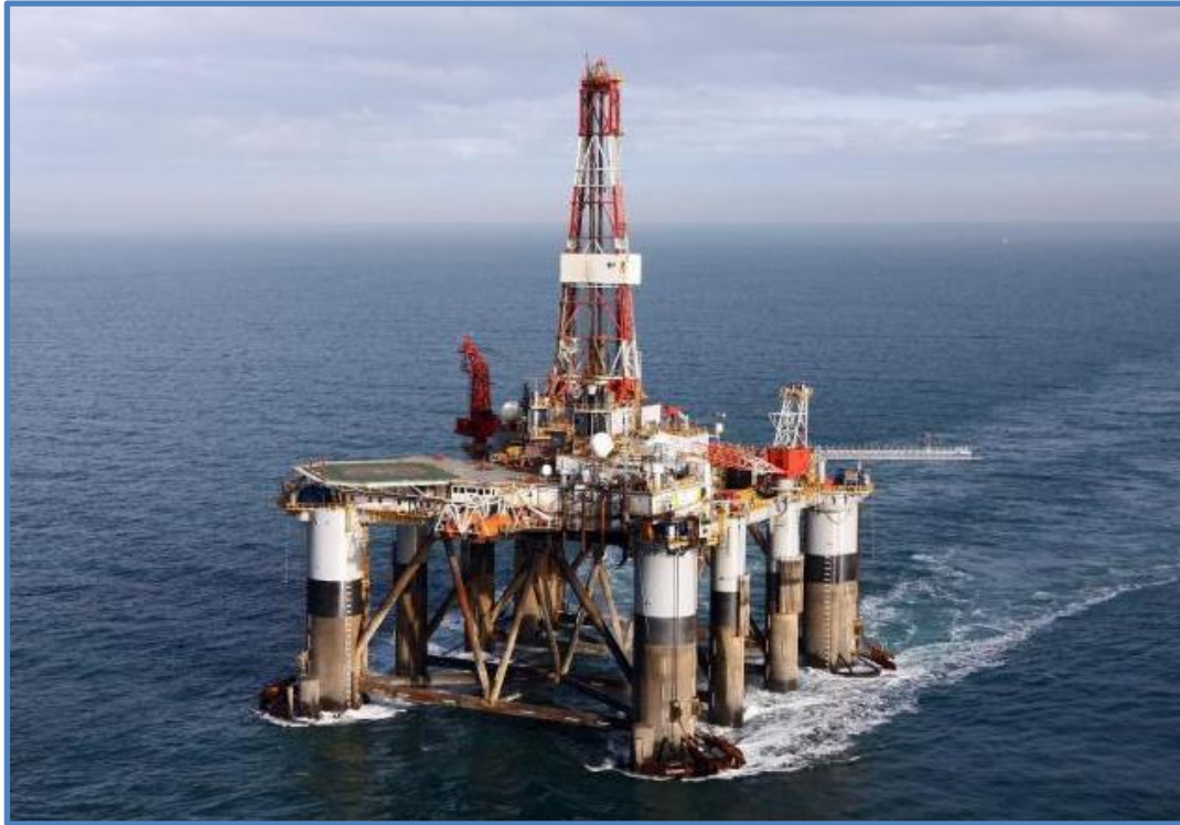
Figura 2- 12 Plataforma perforadora semisumergible Ocean Guardian.
