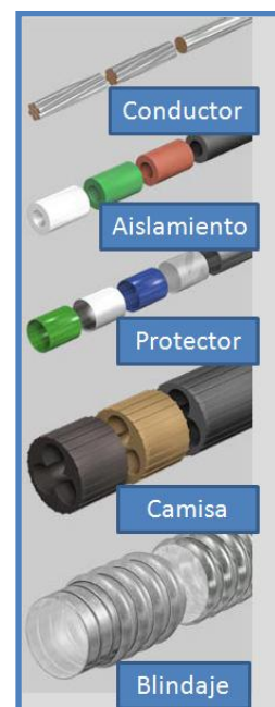
Figura 3- 24 Cable conductor eléctrico.
