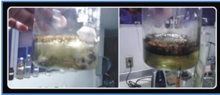
Figura 4- 10 Pruebas para la remoción de asfaltenos en el laboratorio.
