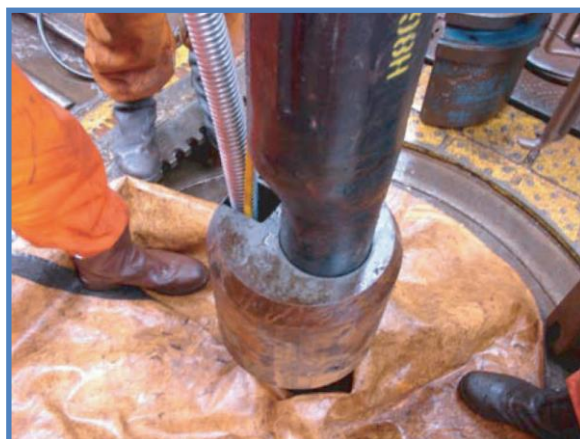
Figura 5-25 Mandril para el BN con la protección del cable.
