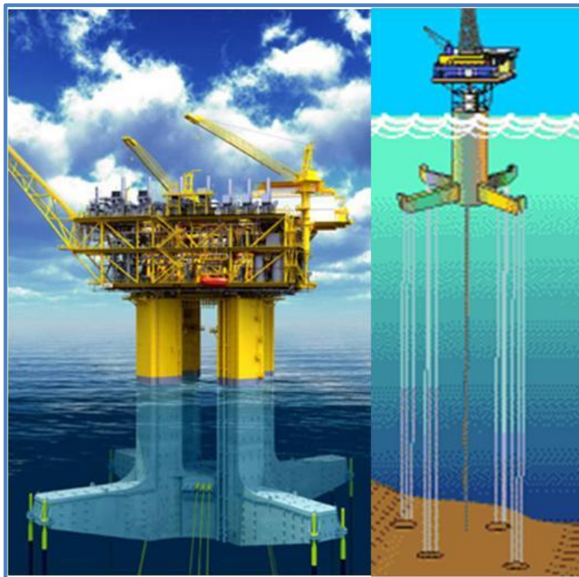
Figura 2- 9 Plataforma de piernas tensionadas TLP.
