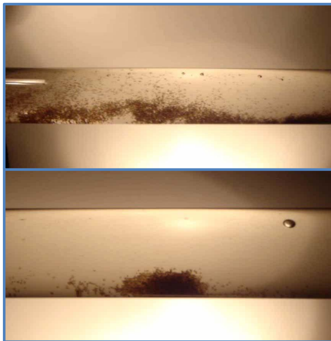
Figura 3- 7 Comportamiento de la arena en la corriente de flujo simulada en el laboratorio.
