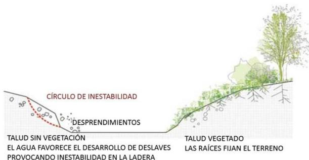
Figura 15. Efecto protector de la vegetación sobre taludes inestables.
