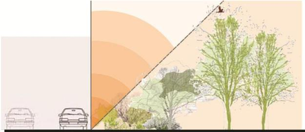
Figura 14. Ejemplo de barrera acústica vegetal densa con diferentes alturas. Basado en Mascaró (2002).
