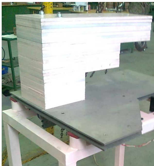
Fig.6.6. Banco de pruebas, sistema antivibratorio y pesos.
