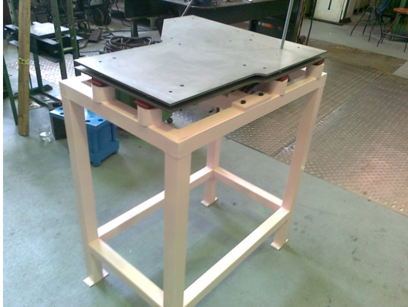
Fig.6.5. Banco de pruebas y sistema antivibratorio.
