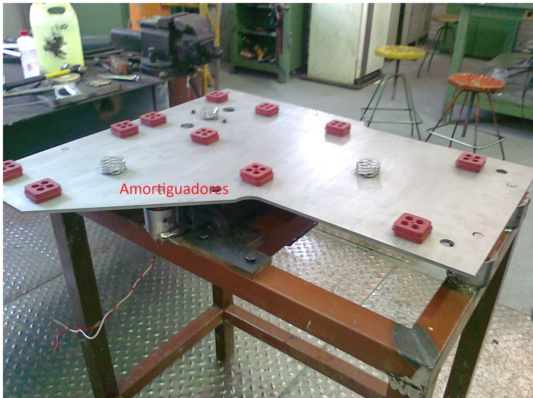
Fig. 5.13. Tercer paso del ensamble del sistema (montaje de amortiguadores sobre la base del sistema).
