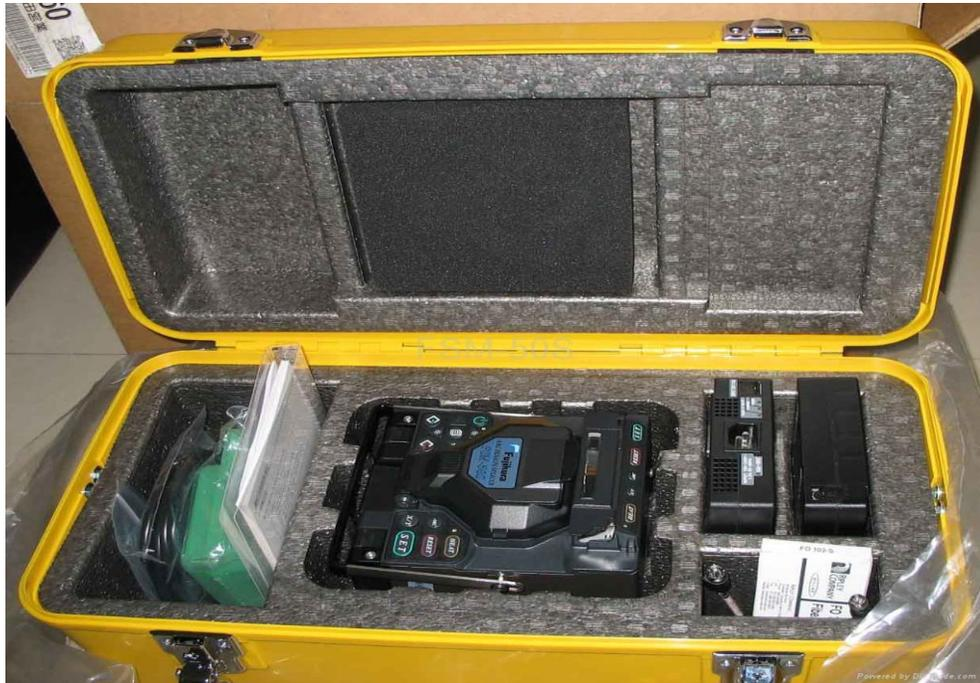
**Figura 26** Empalmadora de fusión
