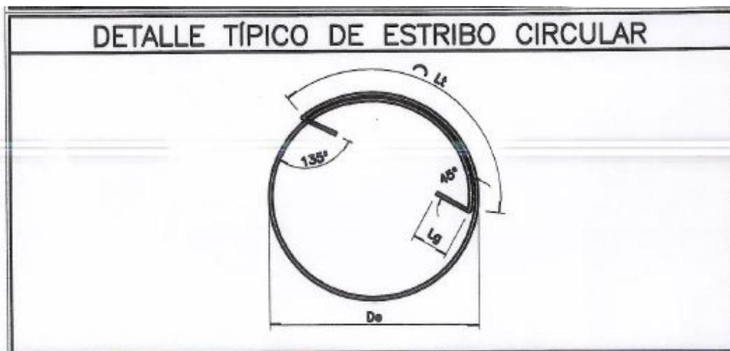
Fig.17 – Detalle típico de estribo circular.
