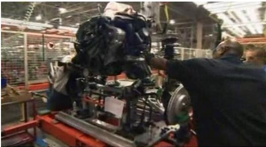
Imagen 4.1. Ensamble motor-transmisión
