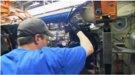
**Imagen 4.18. Instalación de las líneas de frenado**
