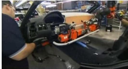
**Imagen 4.16. Instalación de panel frontal**
