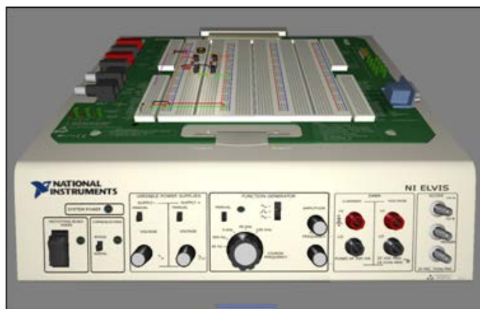
Figura 1. Vista frontal de la estación de trabajo del NI ELVIS en conjunto con la tableta de conexiones
