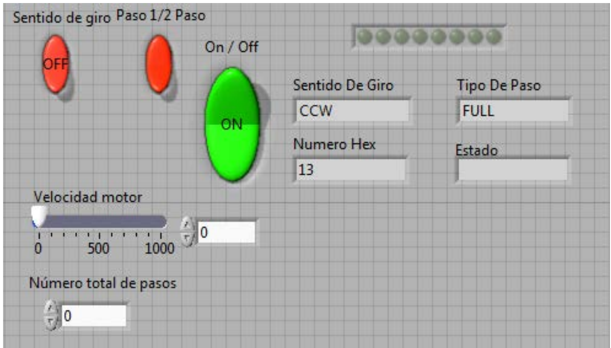
Figura II.6. Cara frontal del VIS. Tablero de control del motor de pasos
