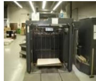
Figura 64. El principio de la impresión offset es que el aceite y el agua no se mezclan.
