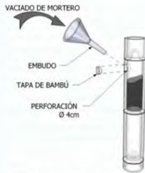
VACIADO DE MORTERO
