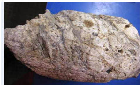
Fig. No 8 Fotos de núcleos corte transversal y lateral, con impregnaciones de hidrocarburo
