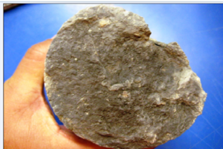
Fig. No 8 Fotos de núcleos corte transversal y lateral, con impregnaciones de hidrocarburo
