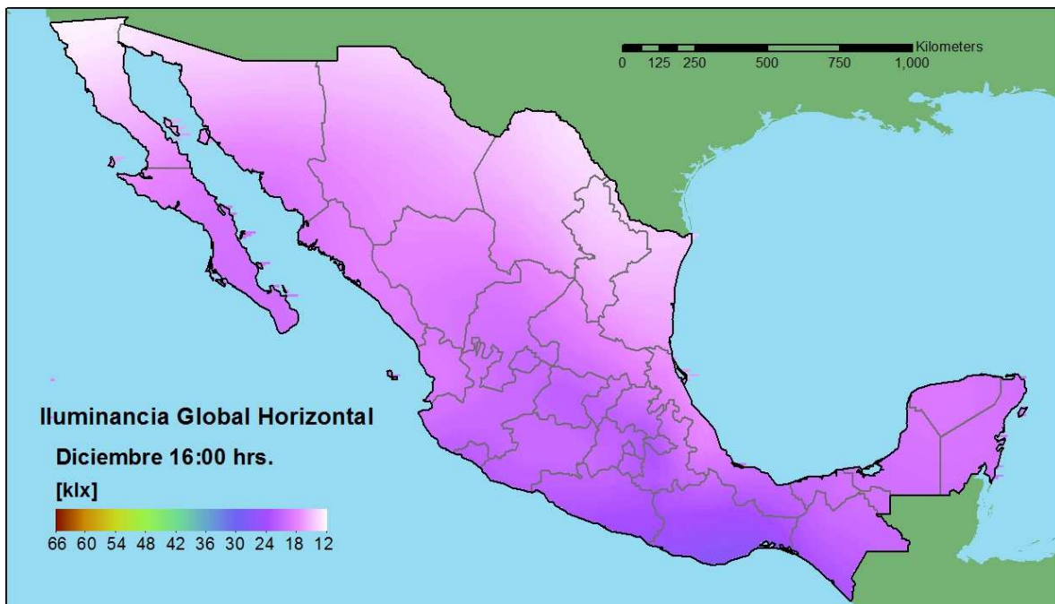
Fig. 5.36 Distribución geográfica del promedio mensual de la iluminancia horaria a las 16:00 hrs del mes de diciembre.
