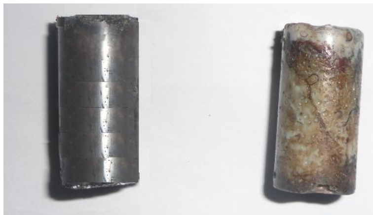
FIGURA 4.9. PROBETAS UTILIZADAS PARA LA REALIZACIÓN DE PRUEBAS MECÁNICAS.
