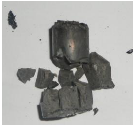
FIGURA 4.10 MUESTRA DEL COMPUESTO DESPUES DE LLEVARSE ACABO LA PRUEBA DE TRACCIÓN
