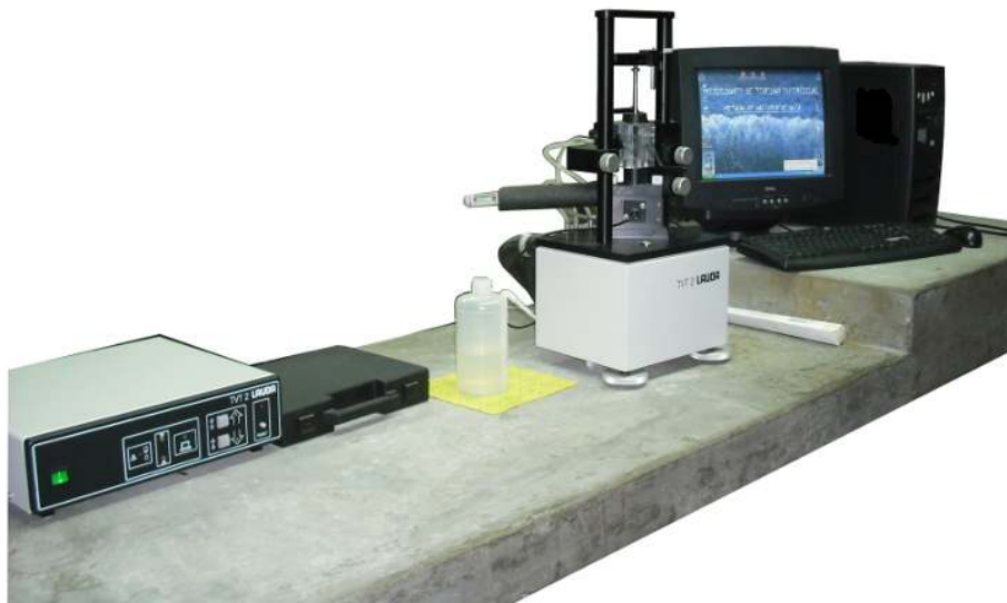
Figura 5.1: Tensiómetro Lauda TVT 2, Volumen de gota.
