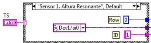
Figura 31. Case structure con valores a asignar en base al estado de “TS”
