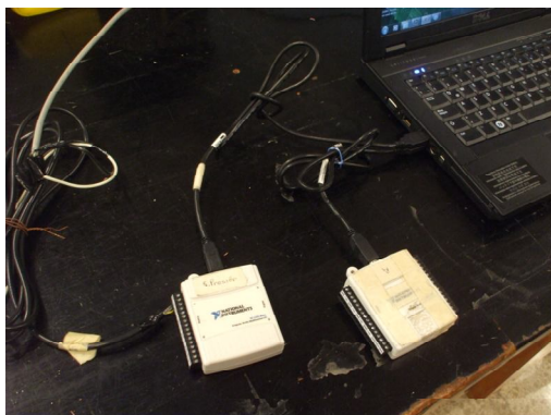
Figura 63. Conexión de las DAQS con la PC y el sensor de presión
