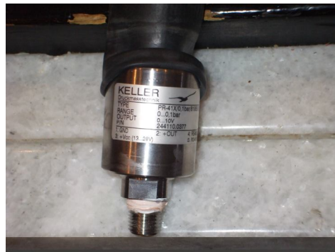
Figura 62. Sensor de presión KELLER
