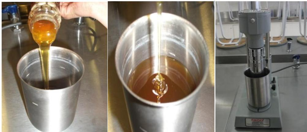
**Fig. 3.6** Procedimiento de medición del esfuerzo de corte.
