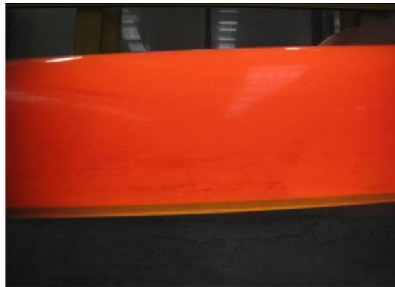
**Fig.4.1** Patrón de flujo estratificado.
