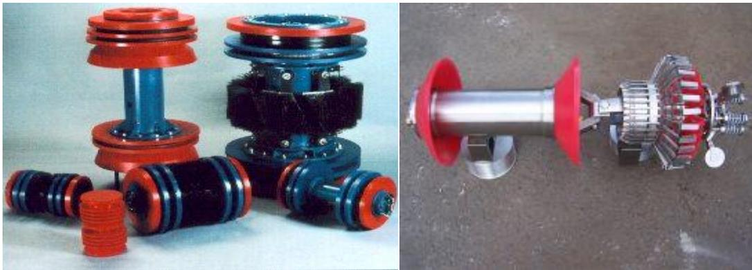
**Fig.1.7** Dispositivos de limpieza en ductos.
