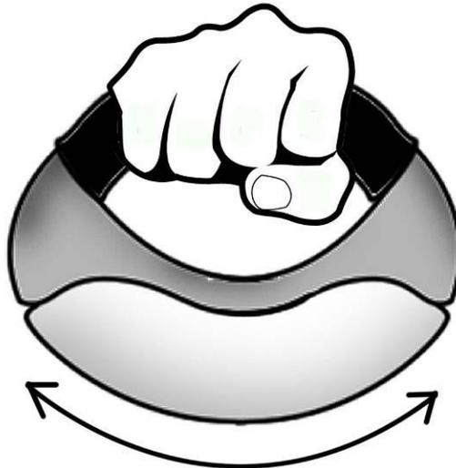
**Fig. 31 \*propuesta de diseño.** Los cuchillos para picar podrían ser circulares y funcionar como lo muestra el diagrama, manteniendo la muñeca alineada, aprovechando al máximo el esfuerzo proveniente de los músculos del antebrazo.
