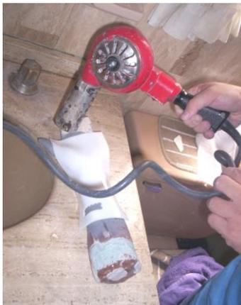
**Imagen 18:** Aquí se muestra el proceso para aplicar el calor sobre la pieza, la ventaja de usar un molde de resina, es que es resistente al calor, y tener una base de mármol también ayuda a disipar el calor alrededor de la pieza.
