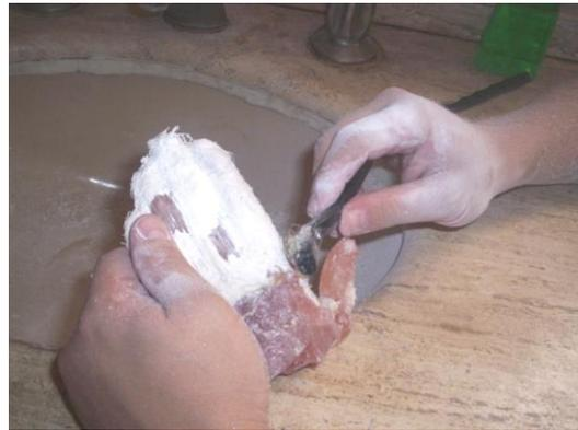
**Imágenes 13 y 14:** Una vez que se termina el vaciado, y la resina endurece, se procede a desmoldar la pieza. Sucedieron algunos problemas, primero; la forma de guante del molde, atrapo la pieza en el interior, esto provoco que al encoger, la pieza se partiera en tres partes. El segundo problema fue que a pesar de la cera desmoldante, trozos de yeso se adhirieron a la pieza, por lo cual tuvo que hacerse un intensivo trabajo de limpieza de la pieza de resina,
