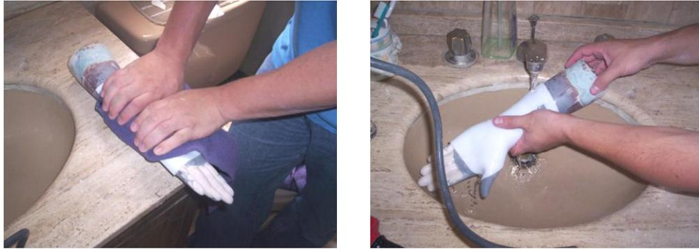
**Imagen 19 y 20:** Una vez que la lámina plástica reblandeció lo suficiente, se toma la toalla húmeda para moldearla sobre el modelo. Para terminar de enfriar la pieza y que mantenga la forma que deseamos, se coloca directamente bajo el chorro de agua fría.
