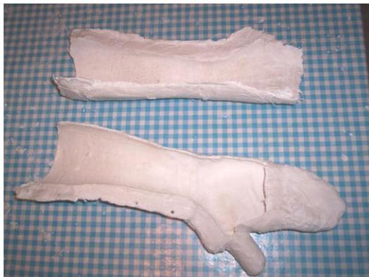
**Imagen 10:** Una vez que quedó lista la primera parte del molde, se realizó la segunda parte de la misma forma. Ambas piezas se dejaron curar, secándose al aire, y se barnizaron con esmalte transparente en aerosol para sellar el poro del material.
