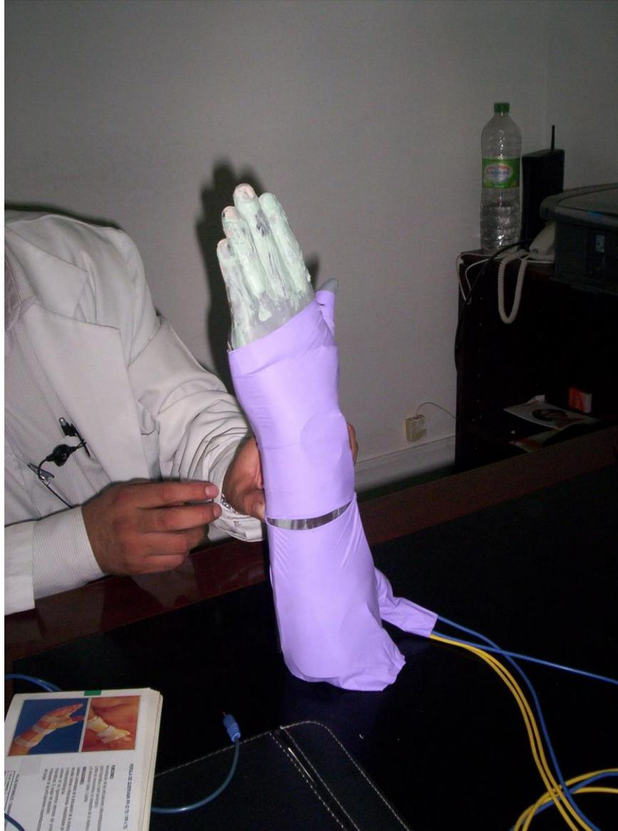
**Imagen 25:** Prueba de cubierta de hule látex para visualizar como se podría ocultar el cableado y los electrodos debajo de un recubrimiento.
