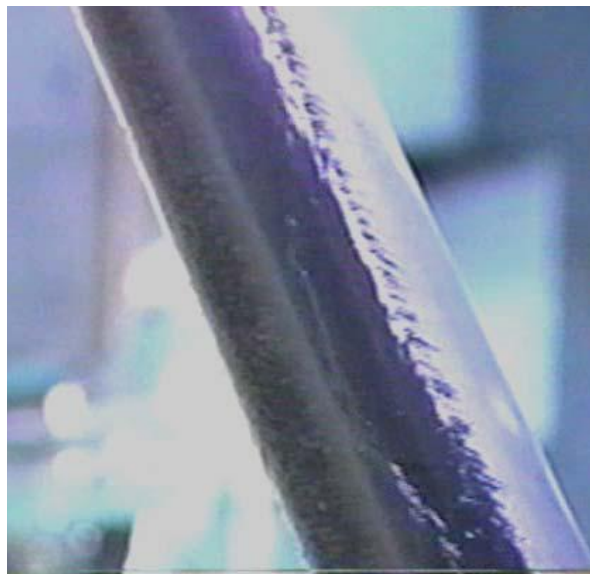
Figura 2.13 Formación de un riachuelo en el tirante de un puente
