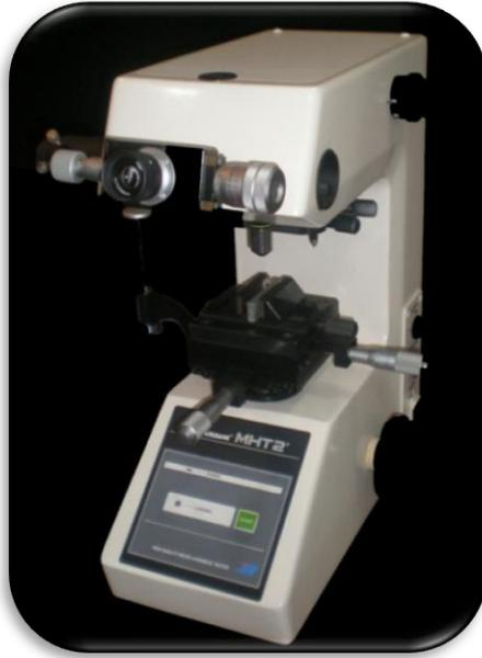
**Figura 12.- Microdurómetro (Matsuzawa MHT2™, Japan).** Fuente directa.
