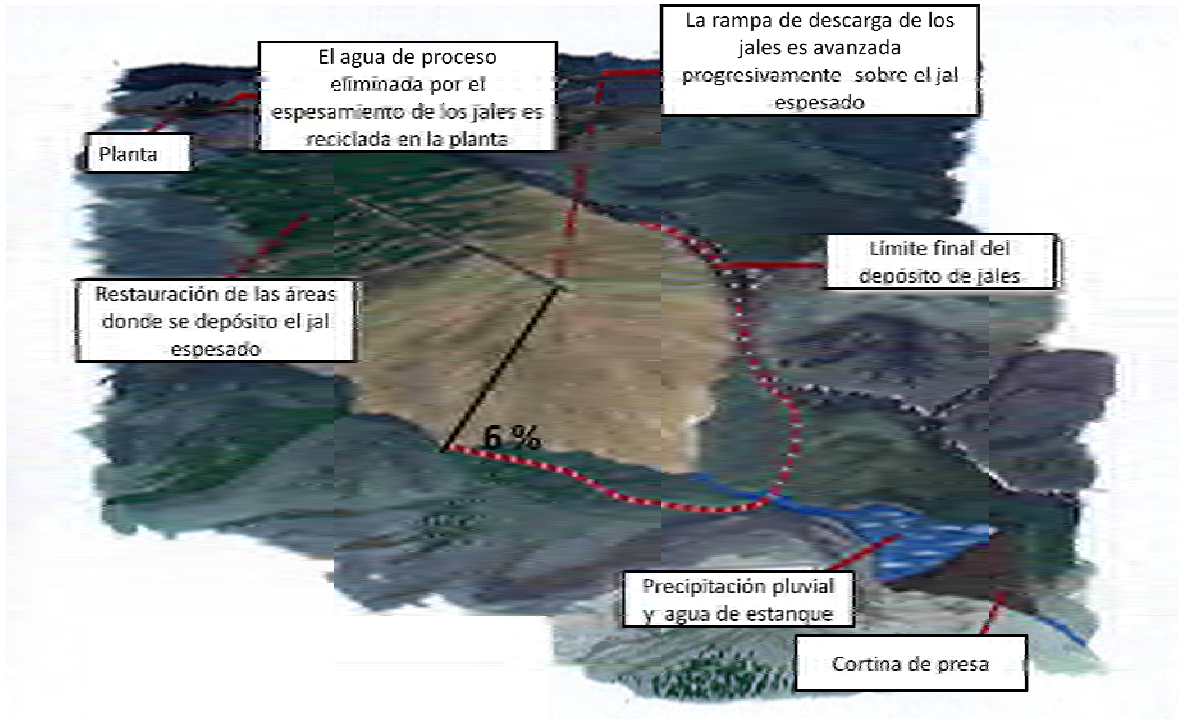
FIGURA 2.1. Método de concentración de sólidos ( http://www.thickenedtailings.com ).
