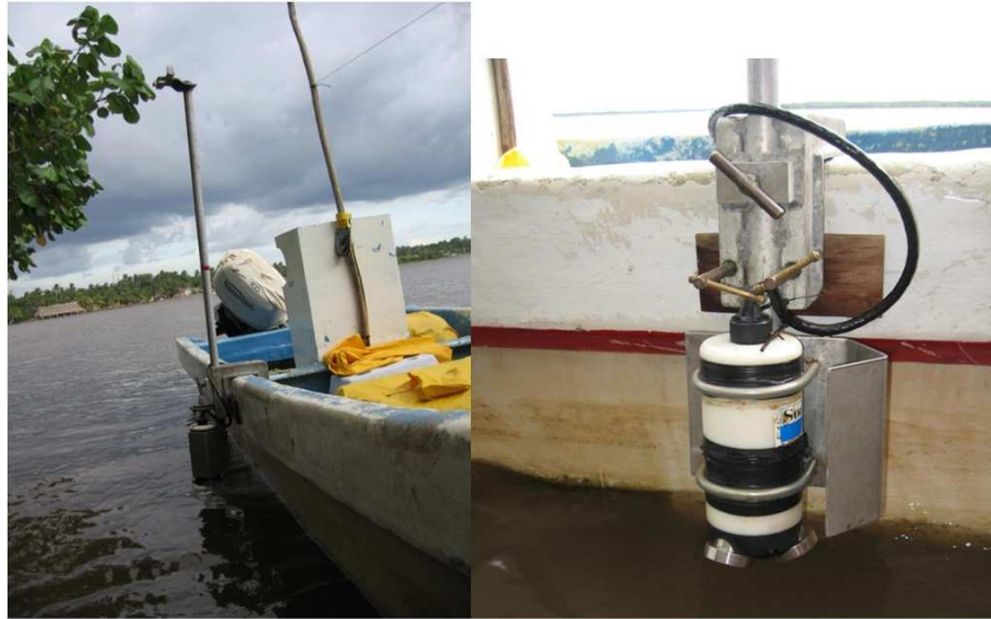
Figura 3.10 Perfilador de corrientes (ADP) instalado en la embarcación utilizada para recorrer los 4 transectos señalados.
