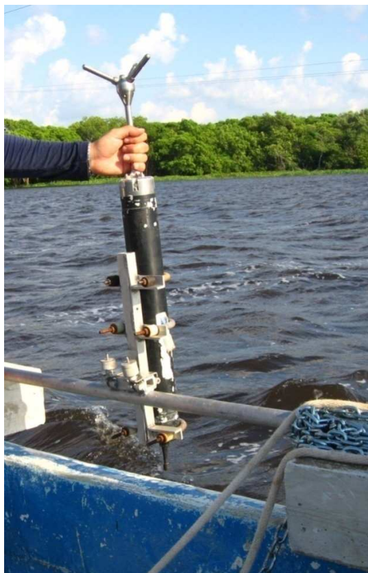
Figura 3.8 Corrientímetro vector utilizado para medir flujo y nivel a 12 km de la desembocadura del río Tonalá.
