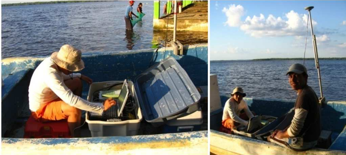
Figura 3.3 Sistema de medición de batimetría. Panel superior: Ecosonda controlada desde una computadora portátil. Panel inferior: antena del GPS diferencial (rover) sujeta a la embarcación y al transductor de la ecosonda por medio de una barra metálica.
