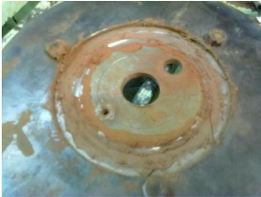
Imagen 16. Tapa del horno del extremo de salida del Trióxido de Antimonio.
