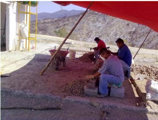
Imagen 6. Muestra la tritución manual del mineral Estibinita.
