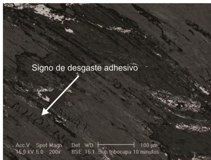
**Figura 4.28 Zona de desgaste adhesivo (10 minutos de ensayo).**
