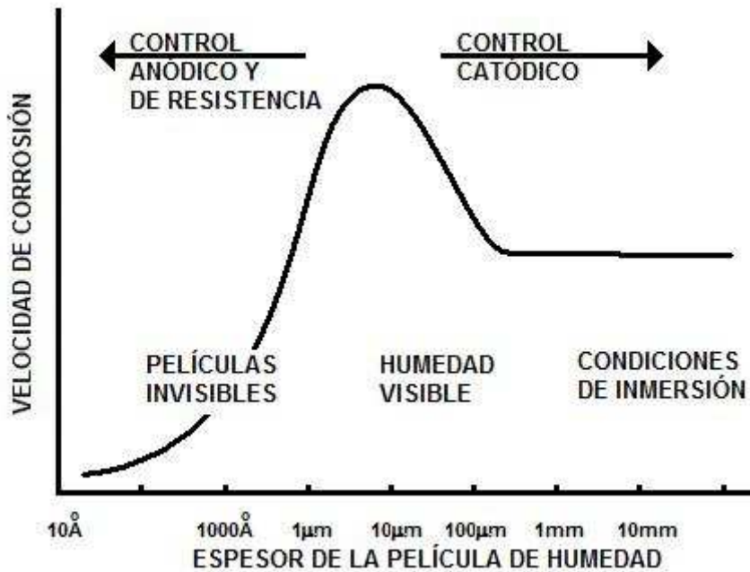
Figura 1 Velocidad de corrosión a diferentes espesores de película de humedad
