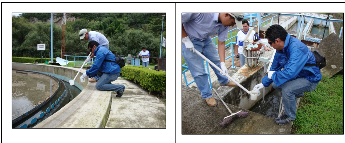
Figura 22. Toma de muestras en pretratamiento y sedimentador secundario
