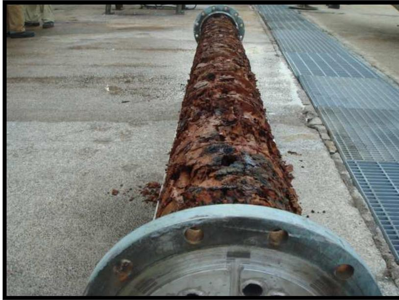
*Figura 1.4. Corrosión en intercambiador de un sistema de enfriamiento cerrado<sup>12</sup>.*
