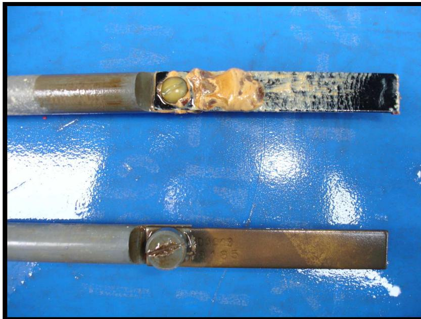
*Figura 1.8. Corrosión uniforme en sistema abierto en circulación<sup>15</sup>.*
