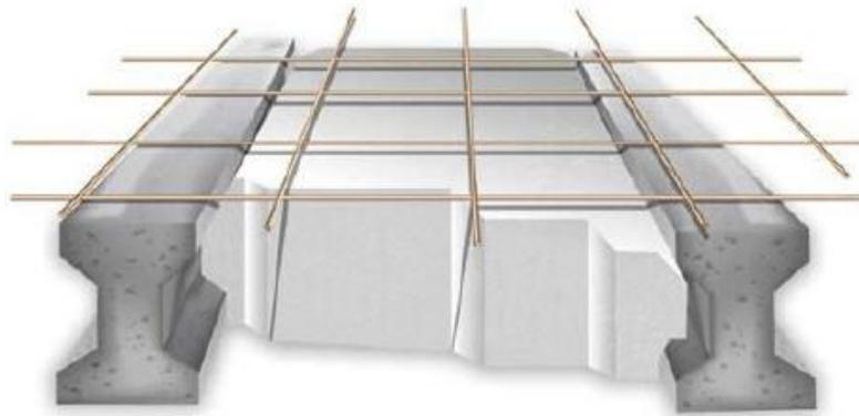
FIGURA 137. Sistema de vigueta y bovedilla.
