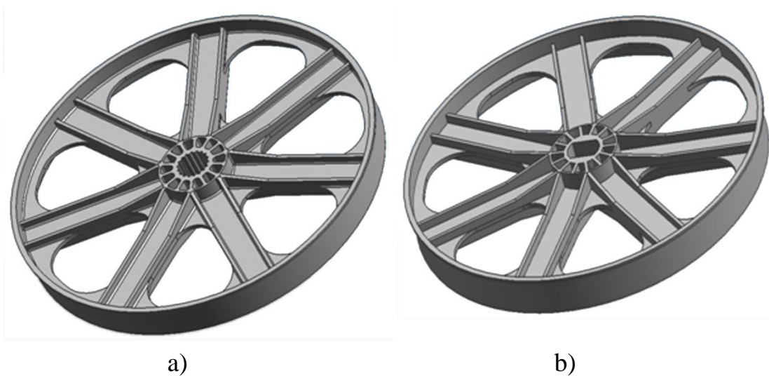
Figura 16. Segundo rediseño de la poea agitador (iteración 2 del modelo geométrico).
