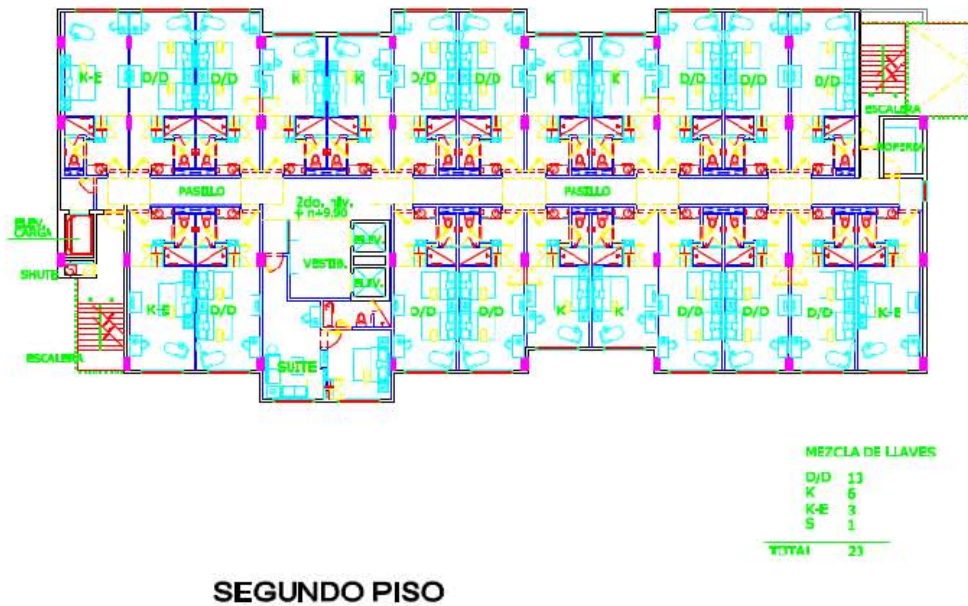
FIGURA. 8.- SEGUNDO NIVEL (VISTA EN PLANTA)
